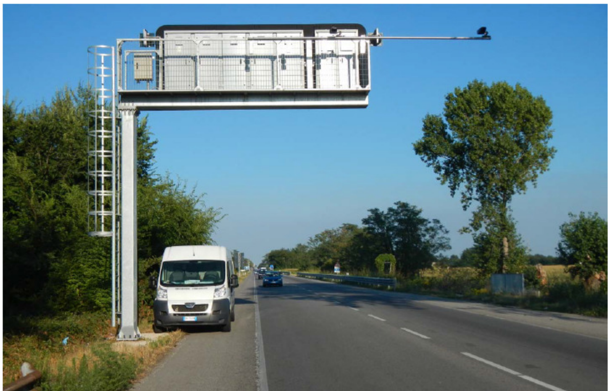
Figura 4: Postazione di rilevamento traffico TOC (NO-03) con braccio installato su una infrastruttura della provincia di Novara.
